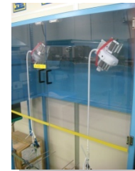
電線の屈曲試験
